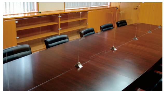
自社製品の飛沫防止パーティション「富岳」。自社のワイヤ放電加工機で加工したスタンドに購入品のアクリル板（板厚3～5mm）を差し込んでいる
