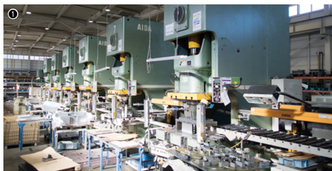
① 200トン×6台のプレスロボットライン（2軸ロボット搬送）。手前からはコイル材、奥からはブランク材を供給。空調エルボや通信機器筐体などを加工する／②金型自動倉庫（右）と小型単発プレス（45～110トン）のグループ（左）。単発プレスは最大250トンまで対応する
