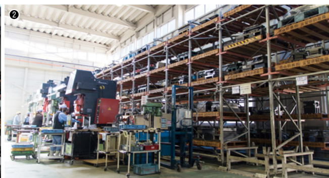
① 200トン×6台のプレスロボットライン（2軸ロボット搬送）。手前からはコイル材、奥からはブランク材を供給。空調エルボや通信機器筐体などを加工する／②金型自動倉庫（右）と小型単発プレス（45～110トン）のグループ（左）。単発プレスは最大250トンまで対応する
